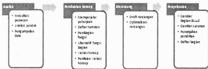
Gambar 4 Diagram metode perancangan
