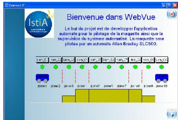
Figure 8 L'interface graphique principale du projet Pont Roulant
