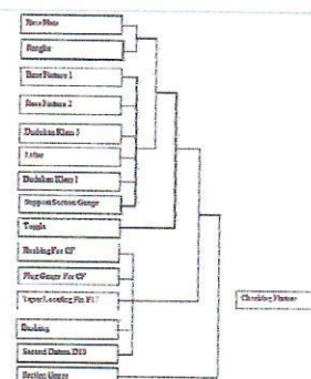
Gambar 2.10 Skema Perakitan Checking Fixture
