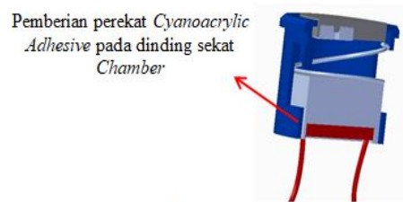
Gambar 3.12 Permukaan benda kerja yang diberi Cyanoacrylic Adhesive pada dinding sekat
