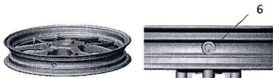
Gambar 3.7 Kontruksi velg ban depan motor dengan lubang nipple (6) yang memiliki konsentrisitas yang baik
