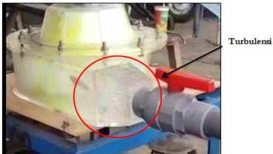
Gambar 10. Turbulensi Pada Pompa
