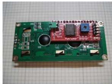
Gambar 2. 2 LCD 20x40 dengan I2C Interface
